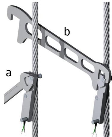
Установка датчиков на кабеле стандартным методом (а) или нашим специальным ключом SW (б).
